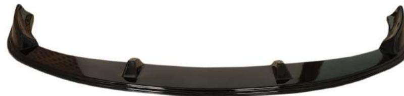
**MERCEDES SPRINTER 2018 ONWARD FRONT SPLITTER**
